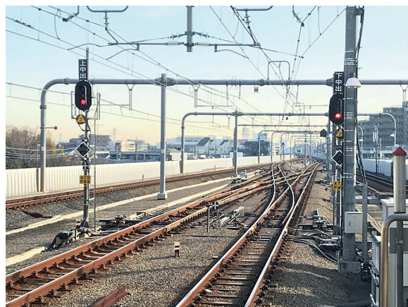
図1 渡り線の線路設備
