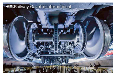
Zefiro ETR1000台車に組み込まれた騒音低減パネル付き輪軸
