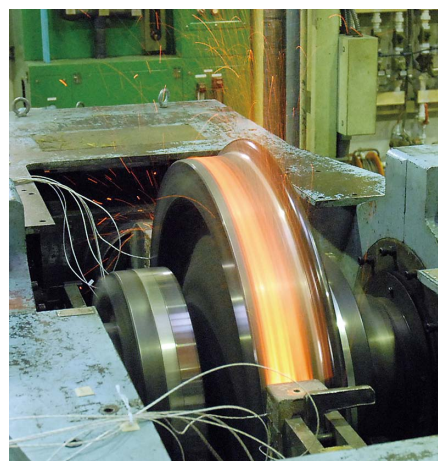
図3 踏面ブレーキ試験ユニットによる試験の例
