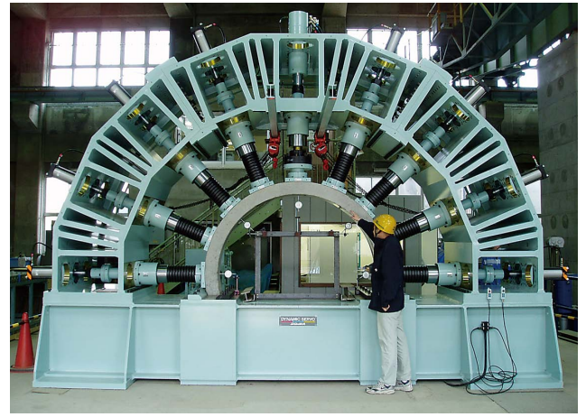
図4 大型トンネル覆工模型実験装置
