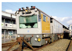
図2 レール削正車
