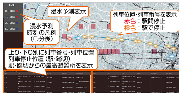
図 浸水向け列車停止位置・避難場所決定支援プロトタイプシステム画面
