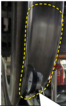
この範囲に車輪偏摩耗が発生していますが、実際に見てもまったくわかりません
