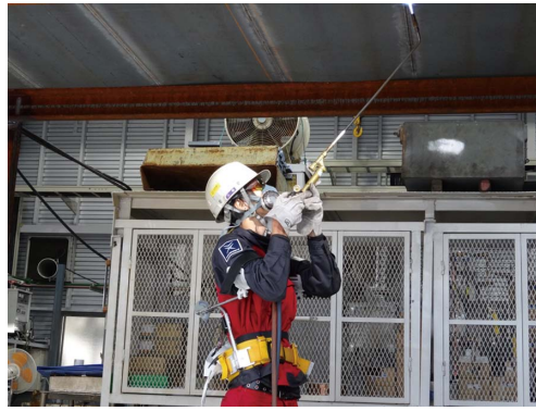
図4 造船上向き作業用アシストスーツ 出典：一般財団法人日本船舶技術研究協会，造船用パワーアシストスーツの開発及び実証実験—造船上向き作業用アシストスーツのプロトタイプ製作—，2017.1
