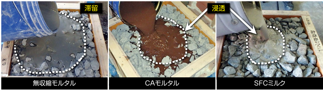
図5 グラウト材の注入状況
