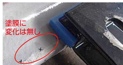
図8 試験後のレール底部上面
