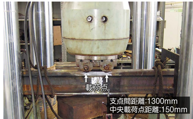
図10 曲げ疲労試験の実施状況
