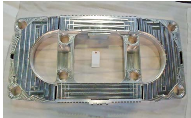
図4 コイルケース外観 (パンケーキコイルを8枚収納)
