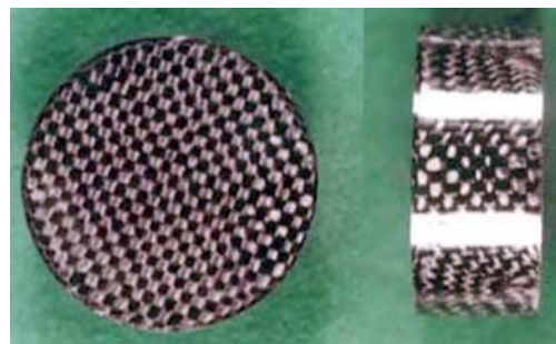
図2 樹脂含浸した超電導バルク体 1)
