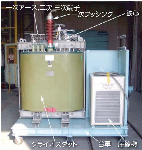
図7 超電導主変圧器
