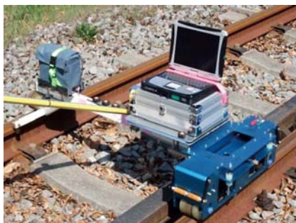
図3 開発したレール凹凸連続測定装置
