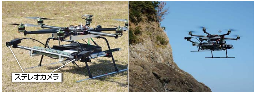
図6 空撮測量システム
