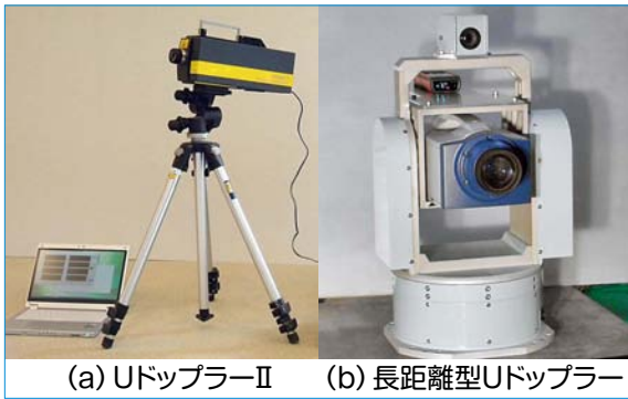
図2 非接触振動測定システム「Uドップラー」
