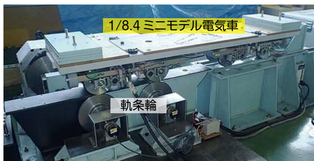
図1 1/8.4 ミニモデル電気車と軸重移動測定台
