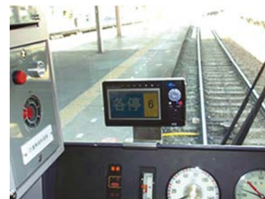
図3 運転士支援システムGPS Train Navi(近鉄車両エンジニアリング株式会社)
