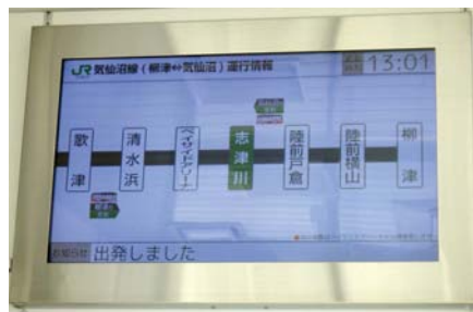
図1 BRTロケーションシステムによる駅モニターの運行情報(東日本旅客鉄道株式会社(JR東日本))
