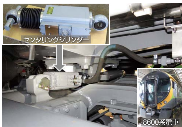
図2 8600系電車に搭載したセンタリングシリンダー
