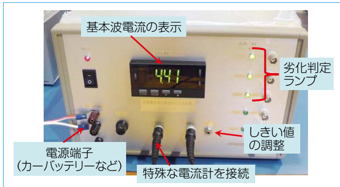
図5 避雷器劣化判定装置の外観図
