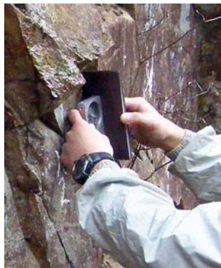
図3 クリノメーターでの計測状況
