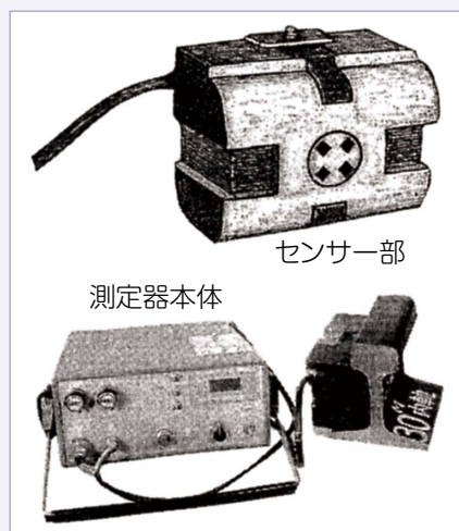
図6 磁気異方性センサーによる軸力測定器 3)
