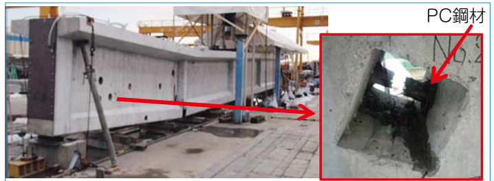
図3 実物大PC桁の載荷試験
