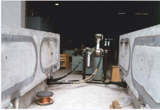
図5 コンクリート埋め込み式の地上コイル
