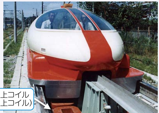
図2 所内の走行試験 (ML 100) における地上コイル
