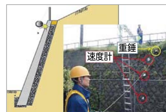
図2 既設土留め擁壁に対する衝撃振動試験
