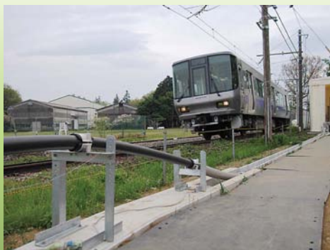
鉄道総研構内試験線における300m級超電導き電ケーブルを用いた走行試験
