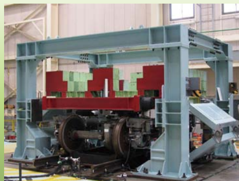
震度7クラスの実地震動の模擬が可能な鉄道総研の大型振動試験装置
