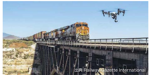
アメリカBNSF鉄道のドローン搭載カメラによる橋りょう検査
