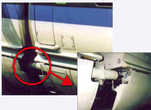
図1 新幹線電車に装備された車体間ヨーダンパー 1)
