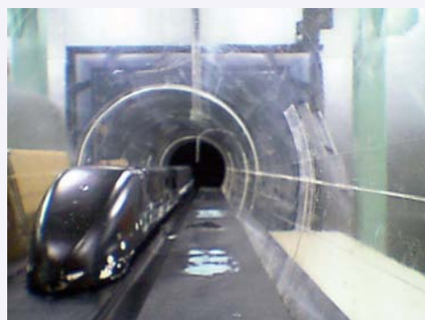
図7 風洞実験(トンネル内の車両)
