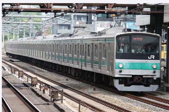
図7 軽量ステンレス車両205系 出典：By JobanLineE531 [CC BY-SA 4.0], via Wikimedia Commons
