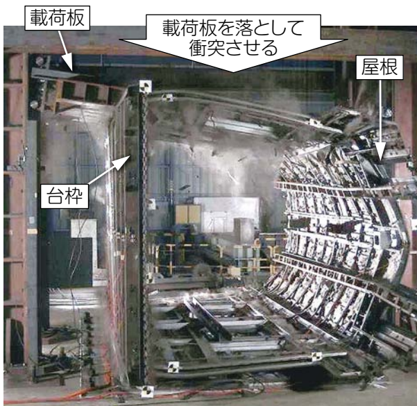
図4 落錘試験の状況 1)
