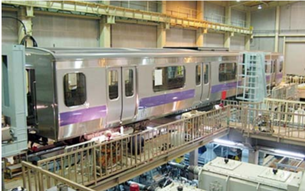
図5 車両試験台試験(軌条輪上転走試験)
