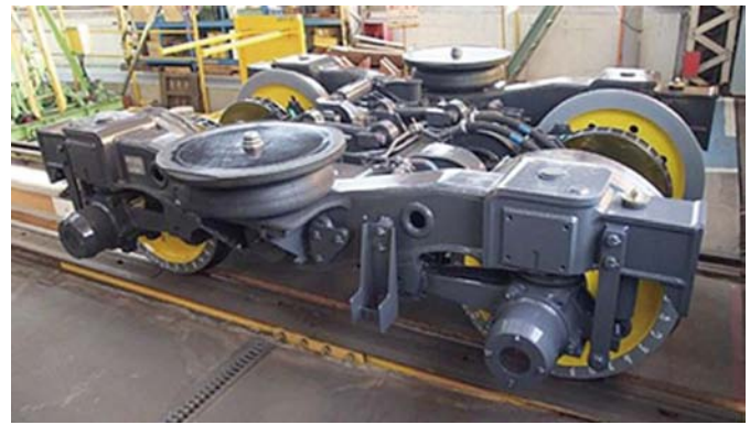
図4 試作した輪重減少抑制台車の外観
