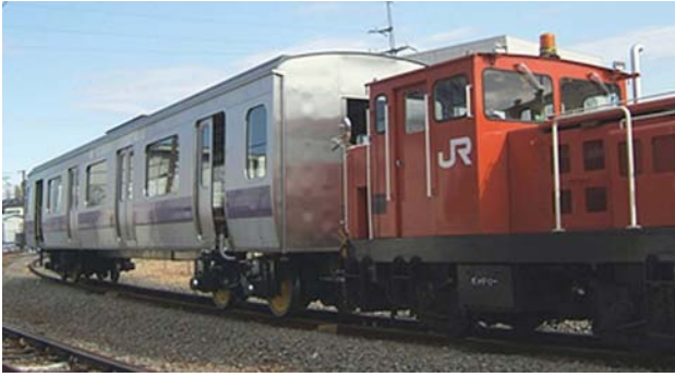
図7 鉄道総研試験線での急曲線低速走行試験
