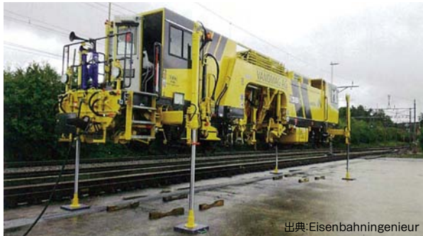
B38Cマルチの4本のリフティング・ラムと側方移動装置
