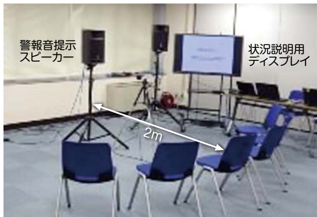
図 音の聴取試験設定
