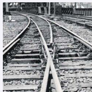
図6 鈍端可動クロッシング 出典：鉄道線路, Vol.20, No.10, 日本鉄道施設協会 2)
