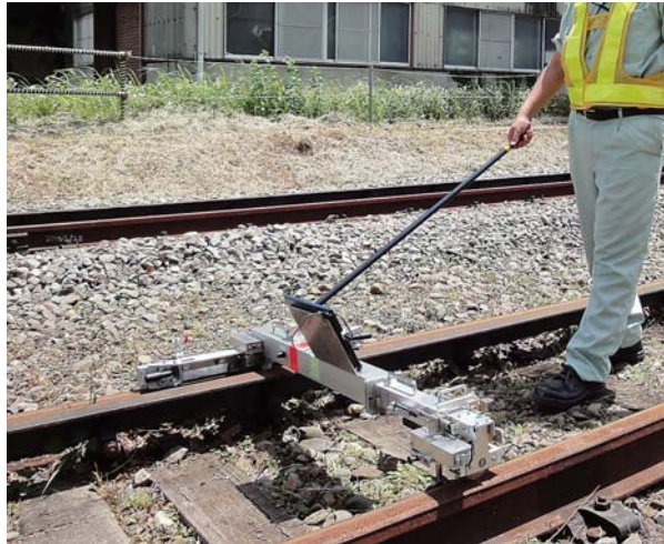
図10 調査研究事業で開発した小型軌道計測装置
