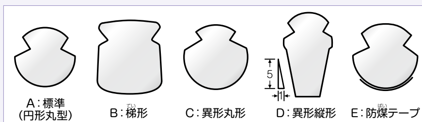
図2 各種トロリー線の断面形状
