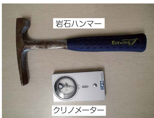
図4 クリノメーター, 岩石ハンマーの例
