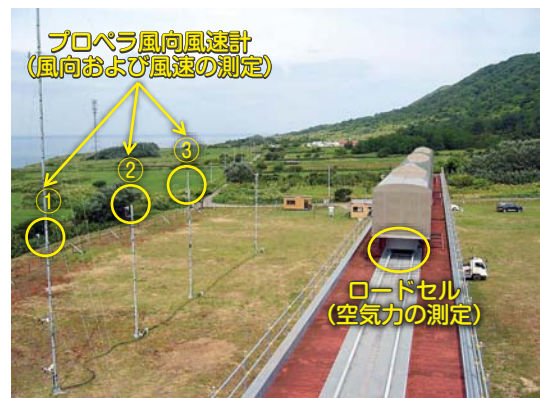
図2 鉄道総研実施の空気力・風向風速測定試験
