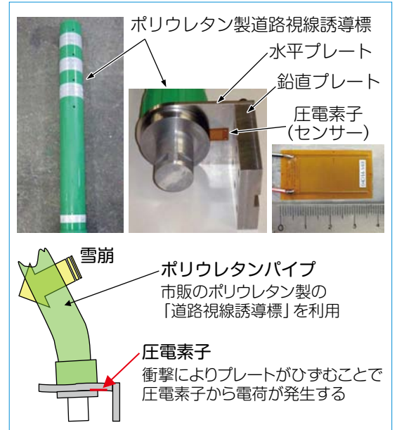
図4 雪崩受圧部の構造
