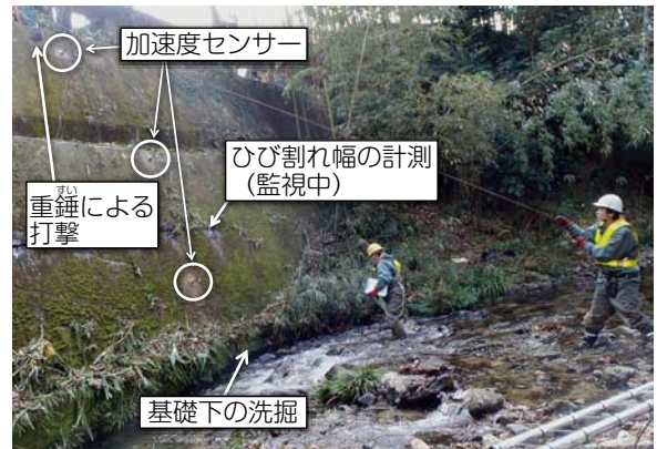
図8 衝撃振動試験の実施状況
