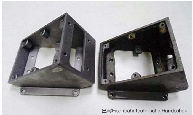
3Dプリンターを利用して積層製造法で作られたICE用主電動機のアルミ製部品
