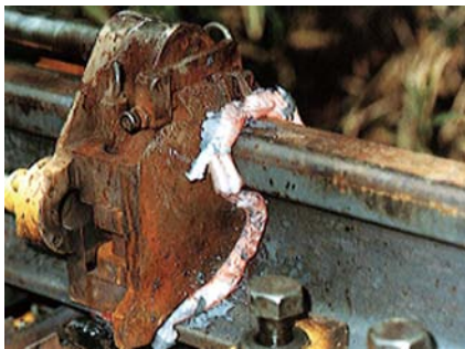
図1 従来型による膨らみの押抜き
