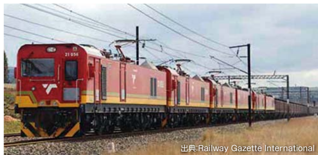
出典:Railway Gazette International 6連のデュアルモード電気機関車にけん引された重軸重石炭列車
