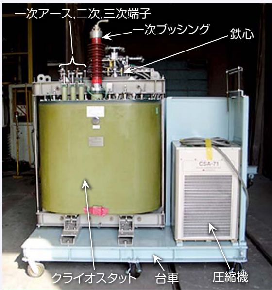
図7 超電導主変圧器
