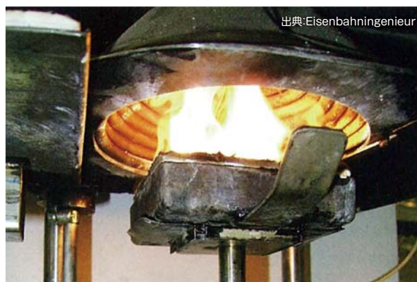
ISO5660-1に準拠するコーン・カロリメーター試験
