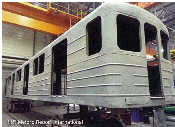
車体には新しい台車や駆動装置が取り付けられます
