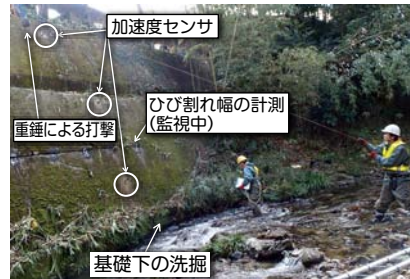
図2 振動試験の実施状況
