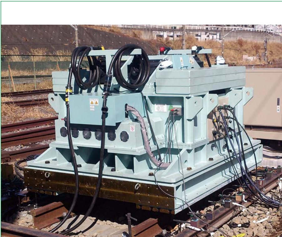
(a) 荷重方向可変式起振機の外観
