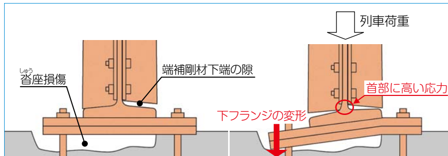
図5 疲労き裂の発生原因
