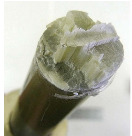
図 蒸留水環境で生じたFRPの脆性破壊の破面
