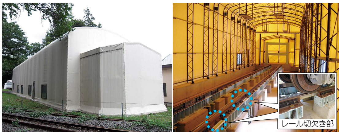
図2 輪軸加振装置が設置されている高周波車両加振試験装置 (左図：外観，右図：内部)
