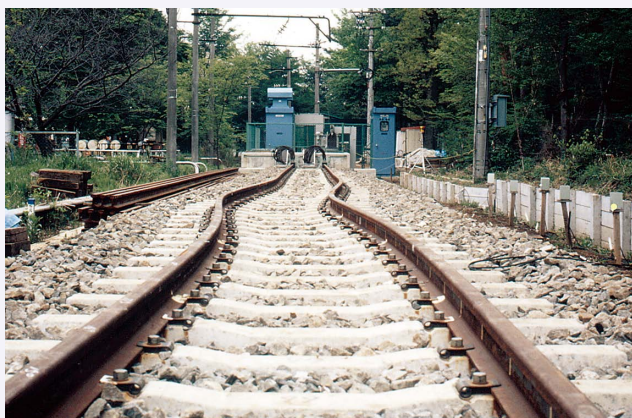
図2 軌道座屈の例（試験軌道による実験結果）
